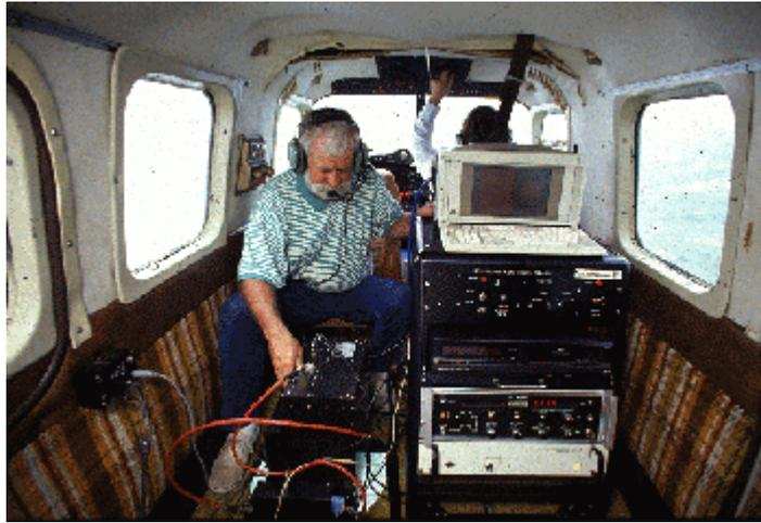
Altímetro láser transportado por avión.
