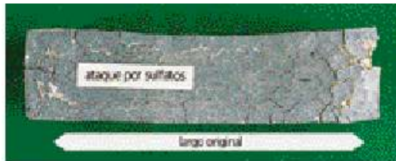
Figura 1.2- Aumento del volumen de un prisma de mezcla inmerso en una solución con alto contenido de sulfatos (mezcla confeccionada con cemento normal).
