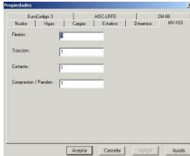
fig. I.25. Valores máximos para los coeficientes de inestabilidad según la norma MV-103.
