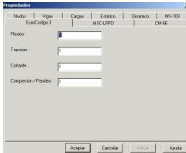
fig. I.26. Valores máximos para los coeficientes de inestabilidad según el Eurocódigo3.
