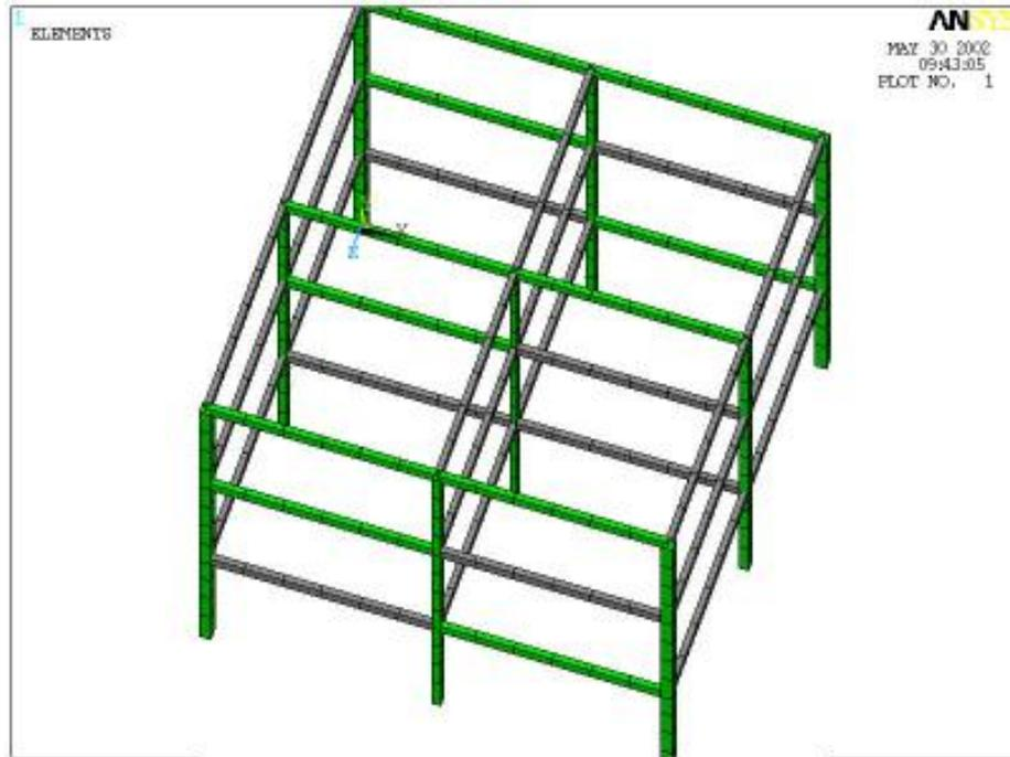
fig. 5.17. Comprobación a compresión de los perfiles de optimización con el módulo CIVILFEM.
