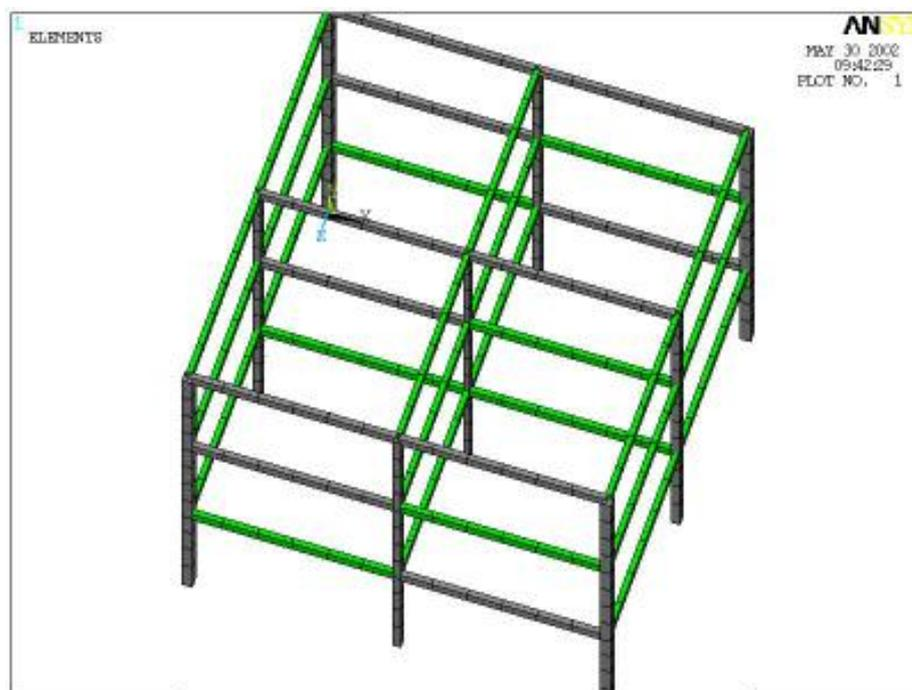
fig. 5.16. Comprobación a tensión de los perfiles de optimización con el módulo CIVILFEM.
